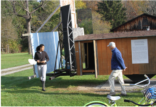
파우더밀 조류충돌실험 시설. 뒤편에 보이는 연하늘색 무늬가 터널 안 조류가 바라보는 하늘무늬다. 내부를 관찰하는 영상을 통해 조류 충돌 위험률을 찾아낸다.
